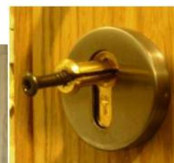
Extractor de cilindros y tornillo de extracción
