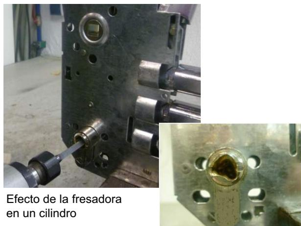
Efecto de la fresadora en un cilindro
