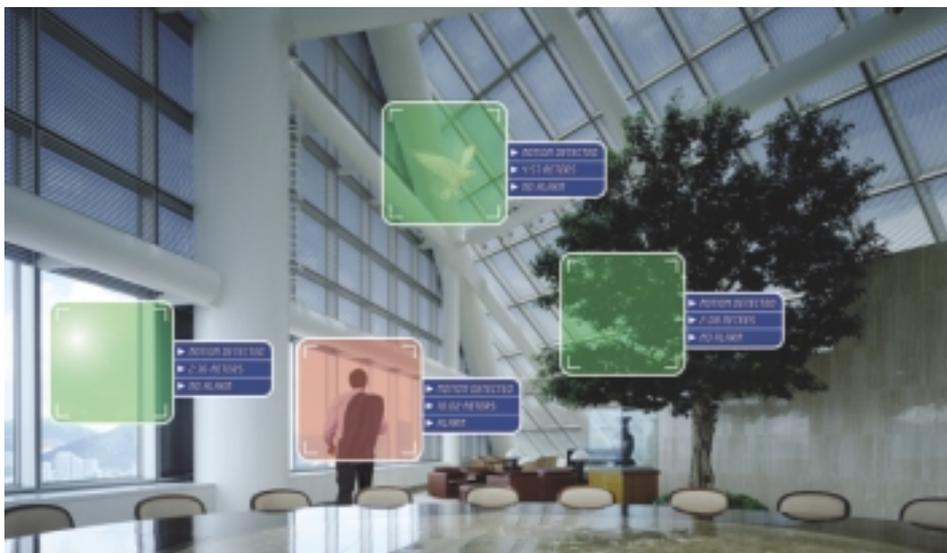
*Detección con fusión de datos de distintos sensores, fiabilidad frente a falsas alarmas*
